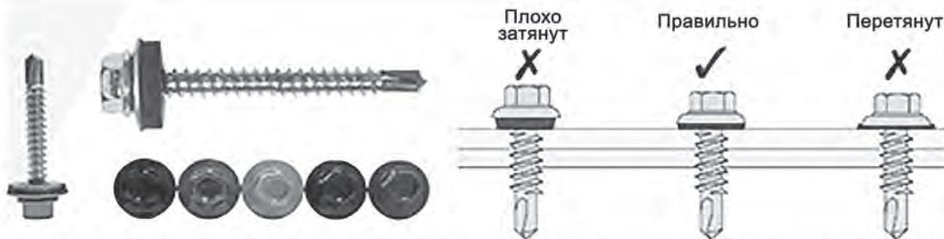
Такие саморезы часто выполняются с цветными головками, что позволяет делать их незаметными на цветном кровельном покрытии. Поскольку герметичность достигается за счет имеющегося резинового уплотнителя, важно правильно смонтировать элемент — не слишком перетягивая и соблюдая достаточную фиксацию эластичной шайбы-прокладки. Качественный и закрепленный по инструкции элемент не подвержен деформации от перепада температур и прослужит очень долго, весь срок службы кровли — до 50 лет.
